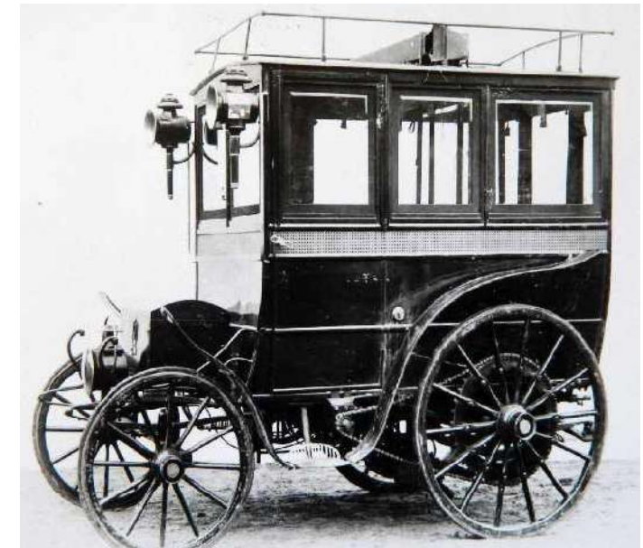
Une Berline de voyage. Notez le système de ventilation sur le toit.
