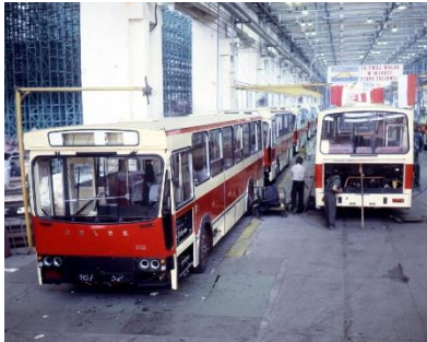
Montage PR100, usine de Jelcz, 1977, Pologne
